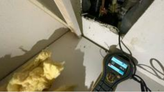
20. mars: Fuktmåling i svill mot sør viser at det er meget fuktig.
