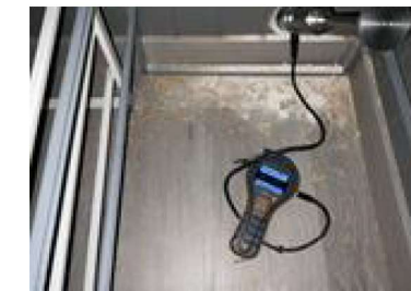
Måling med pigg i trevirke indikerer vektprosent i trevirke under 8%, som betyr at trevirket er tørt
