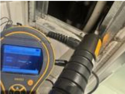
RF Måling av relativ luftfuktighet i veggkonstruksjon via inspeksjonsluke/rørkasse
