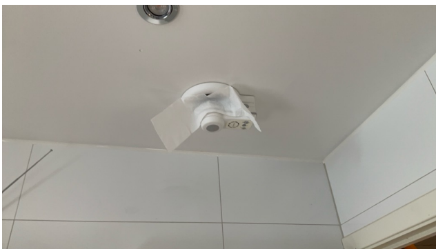
Vifte funksjonstestet med papir.
