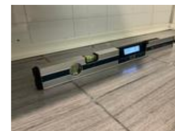
Målingen viser 7 mm/m motfall fra sluk.
