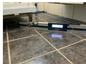
Målingen viser motfall på gulvet ved sluk.
