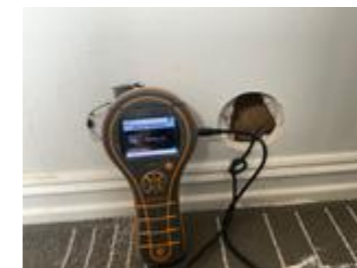
Fuktmåling uten utslag.
