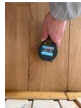
Stue. Målt opptil 21 % med Protimeter MMS 2 og pigger i svill (hvit treverk) i vegg ved hulltagning.
