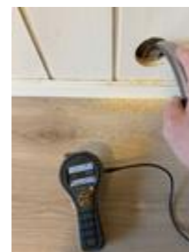
Stue. Målt opptil 21 % med Protimeter MMS 2 og pigger i svill (hvit treverk) i vegg ved hulltagning.
