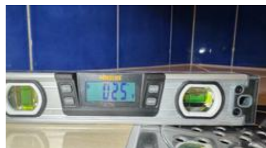
Fall til sluk er ikke i tråd med dagens krav.
