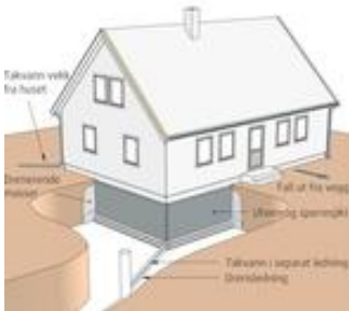
Illustrasjon for drenering og fuksikring av boliger.
