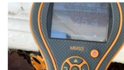
Forhøyet fuktnivå i kledning.
