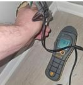
Ingen indikasjon på unormal fukt i veggen
