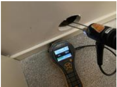
Fuktsøkt i påforet vegg på soverom uten unormale forhold.
