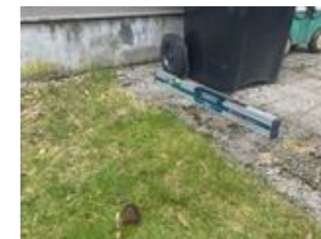
Bildet viser måling av fallforholdet på terrenget som er målt til 2 mm/m
