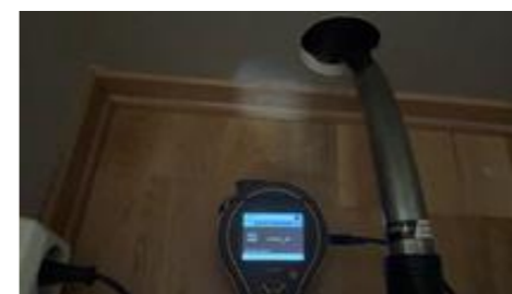
Ingen utslag på fukt ved måling med protimeter.
