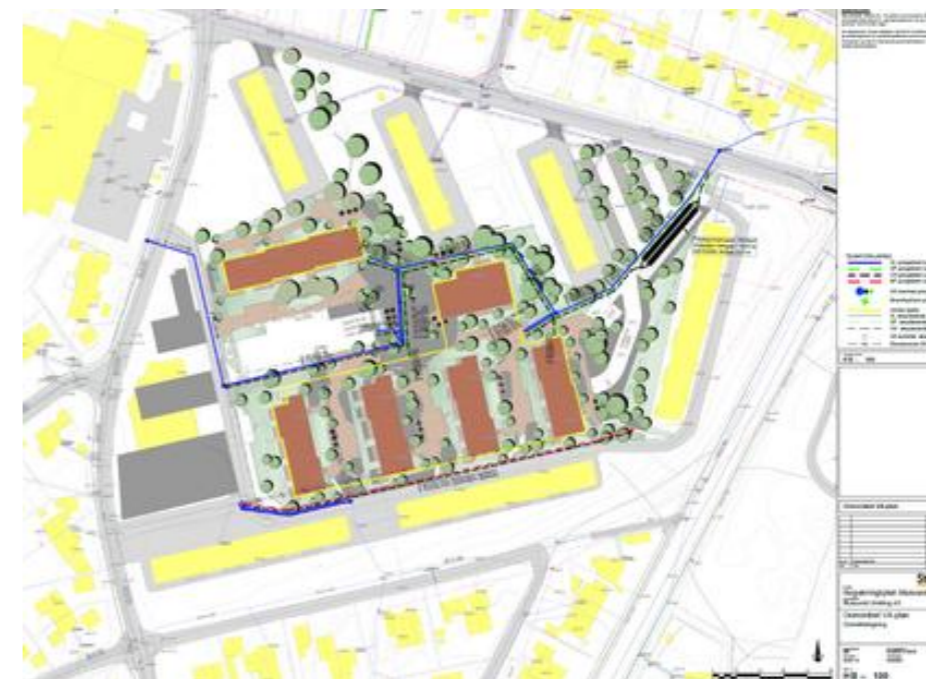
Figur 4-6 Vann og avløp
