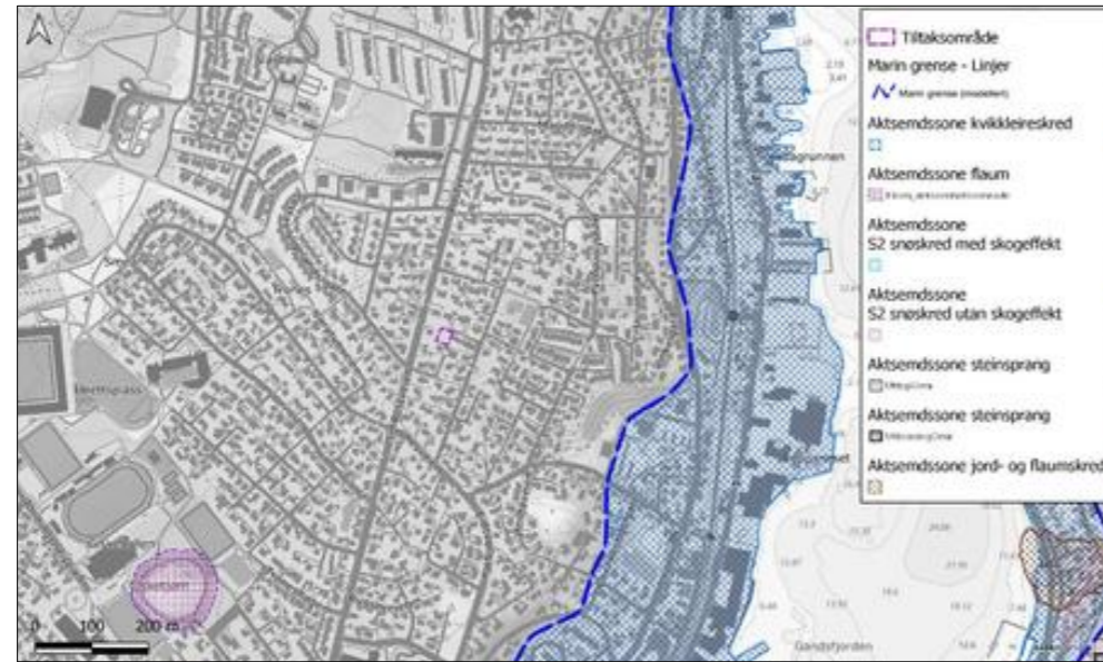
Figur 2: Aktsemdkart for skred i bratt terreng, flaumfare og kvikkleireskred viser at det ikkje er aktsemdområde i nærleiken av tiltaksområdet. Kjelde: temakart.nve.no
