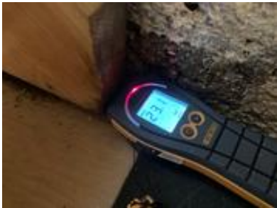
Målt fukt i nedre trappevange mot bakvegg
