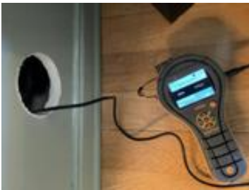
Måling med pigg i trevirke indikerer vektprosent i trevirke under 8%, som betyr at trevirket er tørt
