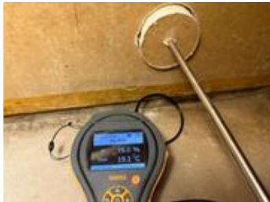
Måling av relativ luftfuktighet.
