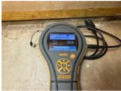
Måling av trefukt/vektprosent.
