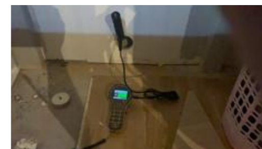
Hulltaking uten unormale resultater i rom under terreng.
