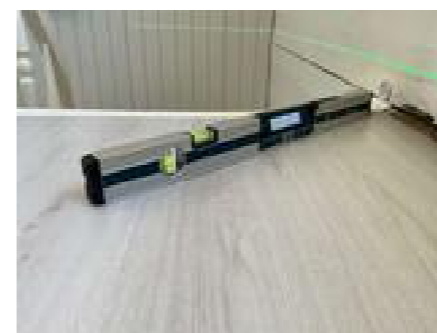
Høydeavvik målt til 23 mm/m.
