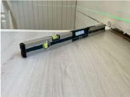
Høydeavvik målt til 23 mm/m.
