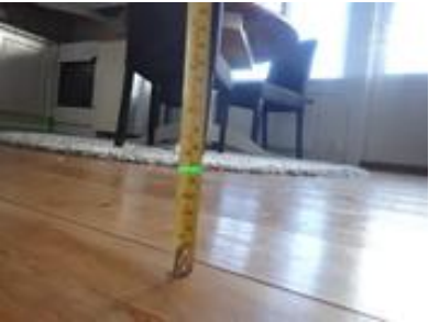
Referansenivå laser = 40 mm. Viser avvik på 25 mm.
