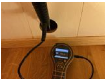
Ingen utslag på fukt ved måling med protimeter.
